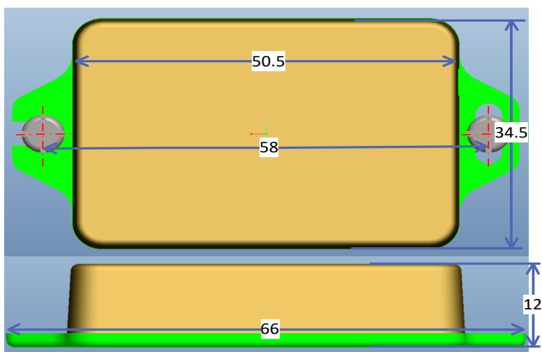
图 2.1 MTW58266G 模块外部塑壳结构尺寸
